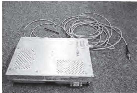
北海道工大などが開発した光ファイバー式の放射線測定器
