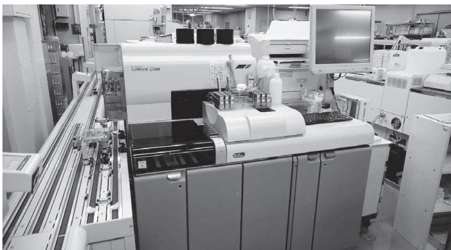
ルミパルスG1200 (富士レビオ株式会社) 化学発光酵素免疫測定法 (CLEIA) を用いている (図1 参照)
