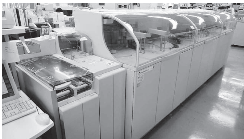
日立自動分析装置LABOSPECT008（株式会社日立ハイテクノロジーズ） 比色測定法、免疫比濁法、ラテックス凝集法・比濁法など
