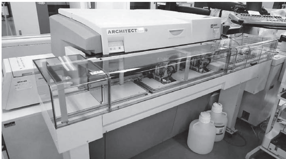
ARCHITECT®アナライザー i 2000SR (アボット ジャパン株式会社) 化学発光免疫測定法 (CLIA) を用いている
