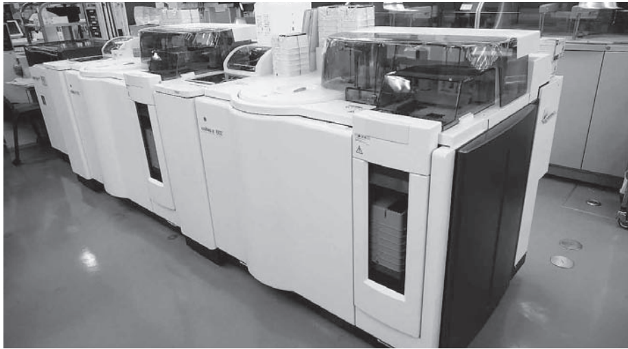
cobas 8000 <e 602> (ロシュ・ダイアグノスティックス株式会社) 電気化学発光免疫測定法 (ECLIA) を用いている
