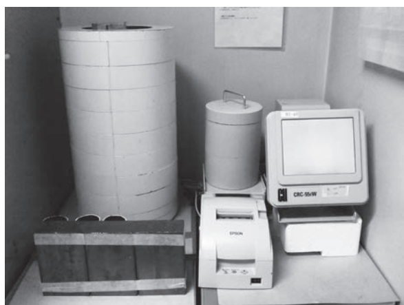
図8 ドーズキャリブレータとウェルカウンタ (CAPINTEC社製CRC-55tW型RIドーズキャリブレータ/ウェルカウンタ)
